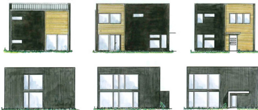
Nymodernistiska villor 2000-2010. Släta ytor av stående träpanel i svart slamfärg och stora samlade fönsterytor. Markerade kontraster i material och kulör. Fönster samlade i grupper (Bilder ur Så byggdes villan, Björk mfl 2009).
