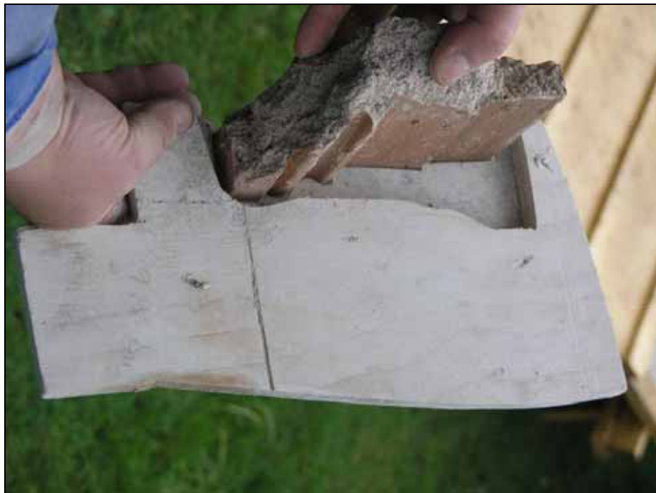
Profilmall tillverkades för lagning av skadade fönsteromfattningar. Foto: Lisa Sundström, 2007. Bild nr: lp20080019
