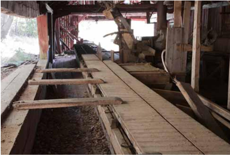
Träarmarna kunde fällas ut när timret skulle rullas över till sågbänken. Foto: Elisabeth Boogh, Stockholms läns museum, 2009, Idng20090836h.
