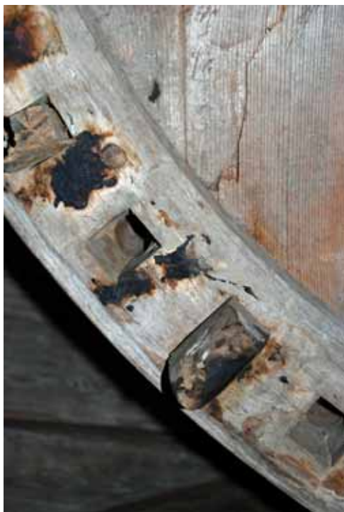
Slitna kuggar och urtag för kuggar. Bildnr Ip20090489
