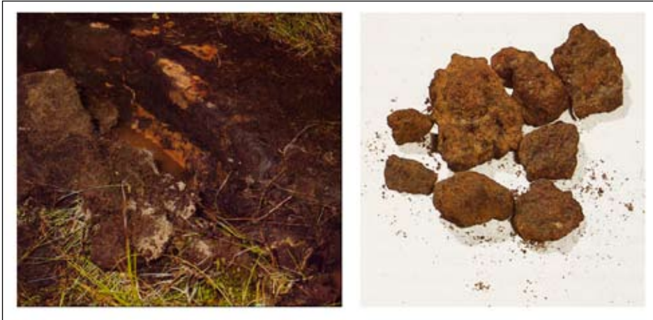
Fig. 7. Bilden till vänster visar hur malm utfälls, dels på de delar av den stora stenen som legat på en viss nivå i myren (vilka blivit mörkfärgade av järnmalmen), dels kring små gruskorn och rötter nere i myren. Bilden är från gränstrakterna mellan Transtrand och Särna i Dalarna. Foto: Petterssons Foto 1980-81. Bilden till höger visar myrmalm påträffad i en bäck vid en vägskärrning drygt en kilometer norr om jäbodstället Tisjölandet i Lima, Dalarna. Den största biten är 6,5 centimeter i diameter och väger 70 g. Foto: Petterssons Foto 1980-81. Ur Pettersson 1982a:40
