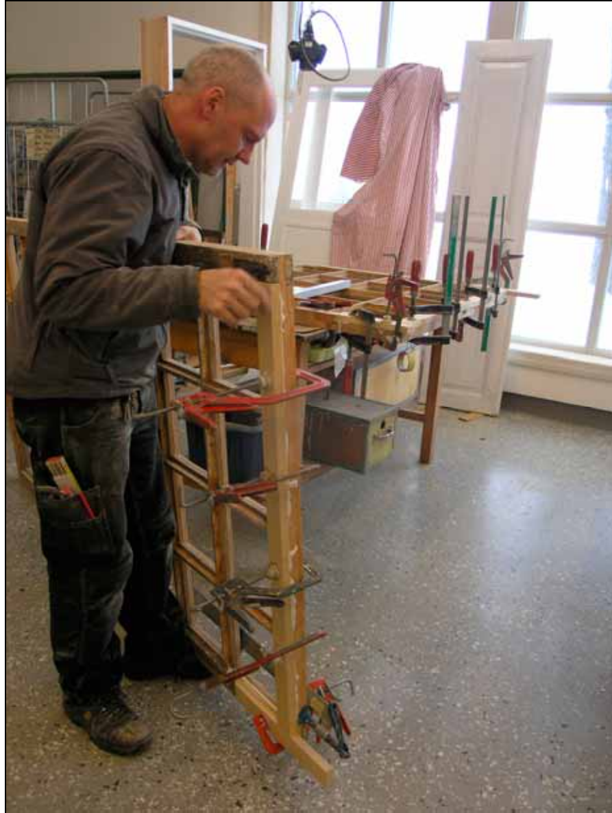
Lagning av bottenstycke hos Uppsala Fönsterhantverk AB.
