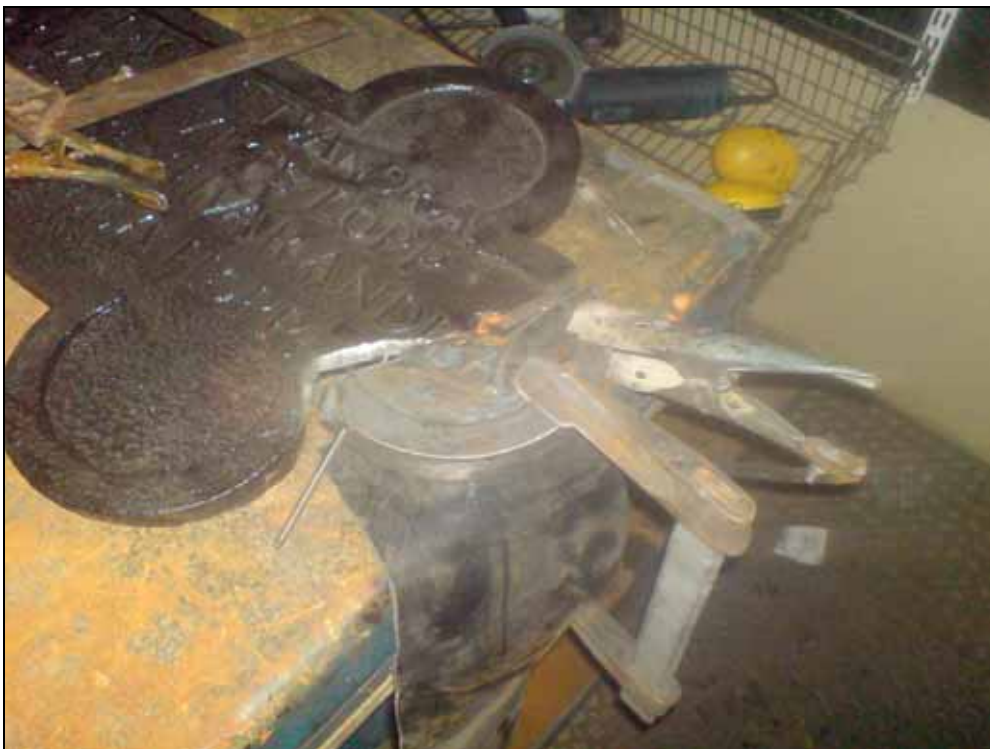
Inpassning och montage av den nygjutna delen på korsarmen.
