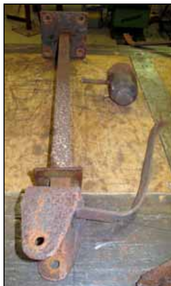
Fäste och fjäder av smidesjärn samt slagkula före renovering. T.v Bildnr: Ip20100470 och t.h. Ip20100471
