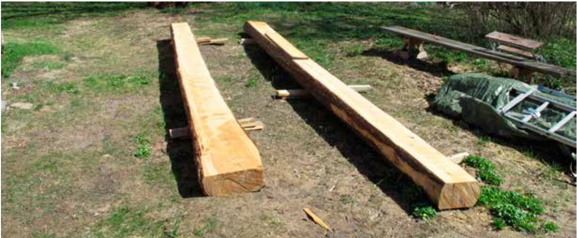
Fig.2. Lokalt fälld furu redo att användas till timmerlagning. Foto Albin Uller 2013. Lp201300510.
