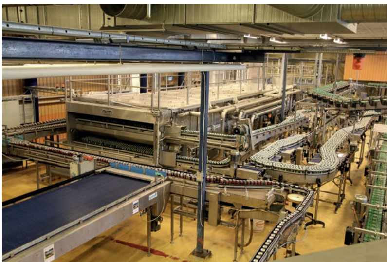
Tunnelpastöriseringsmaskin. Burkarna som kommer på transportbandet i förgrunden är på väg till pastöriseringsmaskinen bortre ände där de förs in i maskinen i två våningar. På maskinens hitre sida kommer de färdigpastöriserade burkarna ut på två transportbanor för vidare transport till inplastningsmaskinen för burkar. Till höger i bild skymtar de färdiginplastade burkarna som är på väg till trågmaskinen. Foto HL.
