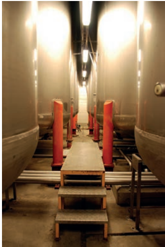
Inför tappningen mellanlagras det färdiga ölet i tolv trycktankar som står i ett kylt rum. Foto LKU.
