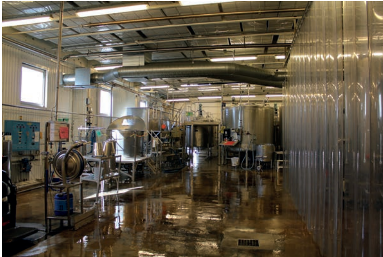
Längst in syns tankarna där läsk och vatten blandas, så kallade syruptankar. Till höger bakom plastskynket finns mixarna. Foto HL.
