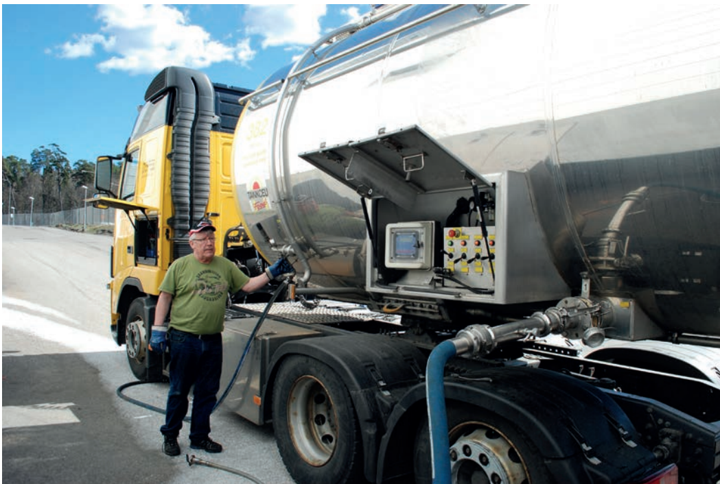
Specialöler tappas inte i Värby utan körs med tankbil till Spendrups bryggeri i Grängesberg för att tappas där. Bilens tank är en så kallad trycktank som först fylls med vatten och sedan läggs ett kolsyretryck på för att all luft ska försvinna innan öl fylls i tanken. Bil och släp rymmer ca 40 m 3 . Timo Ikkonen fyller på vatten i tankbilen. Foto LKU.
