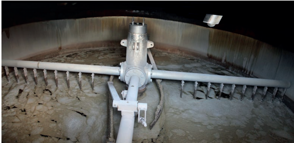
I silckaret syns den så kallade upphackaren som sakta roterar runt i silckaret och med hjälp av knivar luckrar upp filterbädden av drav. Foto HL.
