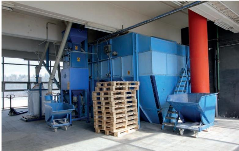
På plan 7 syns undersidan av maltsilorna som rymmer 20 ton vardera. Den övre delen av silorna finns på plan 8. Skruvtransportörer för malten från silorna till malkrossen. Foto HL.
