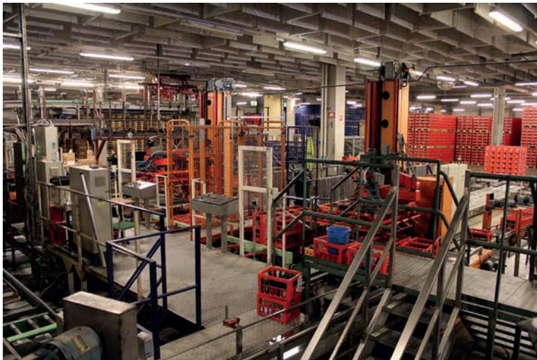
Kombimaskinerna. En pall med backar kommer fram på vänster sida om den högra kombimaskinen. Maskinen lyfter av backarna och ställer dem på en lådtransportör, som finns på höger sida om maskinen, och tar dem vidare till sorteringen. Foto HL.
