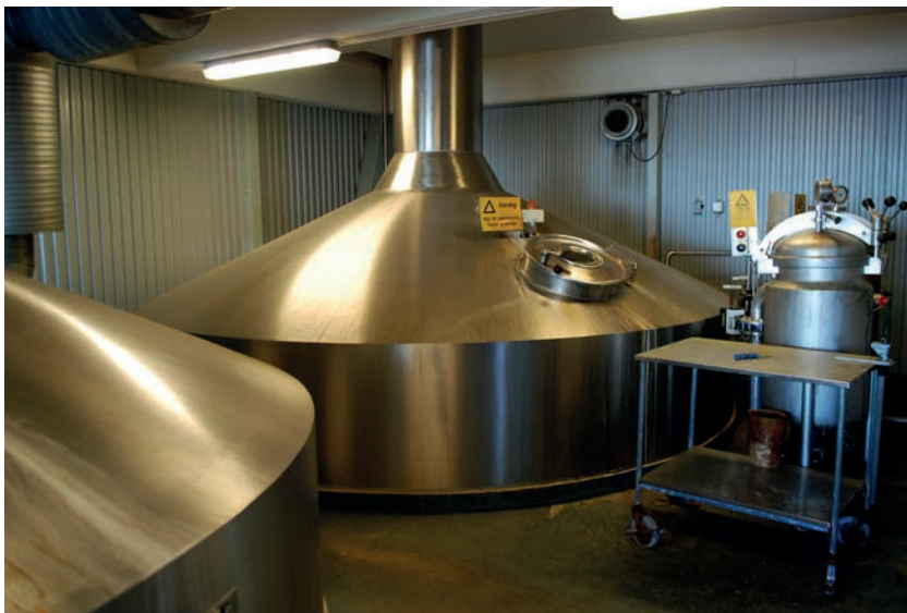
I ett litet trångt rum på plan 4 i bryggerhuset finns vörtkokaren (i mitten) och utslagskaret (till vänster). Vid pågående kokning är det mycket varmt och fuktigt här. I bildens högra del syns de tre humlebehållarna varifrån humlen tillsätts under kokningen. Ölets karakteristiska bittra smak kommer från humle. Foto LKU.
