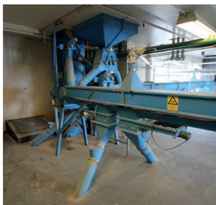
På plan 8½ finns skruvtransportörer som för malten från vägen ner till de 18 maltsilorna, 10 silor som rymmer 150 ton vardera och 8 silor som rymmer 20 ton vardera (på plan 8). Den undre delen av maltvägen syns uppe i taket. Rören som går ner genom golvet leder malten ner till respektive silo. De är märkta med silonummer samt luftspjällsventil. På väggen sitter ett styrdon för luftspjällen och den styrs från elskåpet som finns på plan 8. Foto HL.
