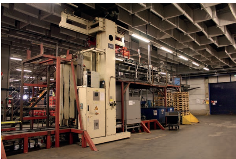
Nyglasmaskinen för 50 cl glas. Till vänster om maskinen ställs en pall med nya glas. Maskinen plockar sedan av glaset varv för varv. Till höger om maskinen syns en grå låda, ett pallmagasin, där de tomma pallarna samlas. Foto HL.
