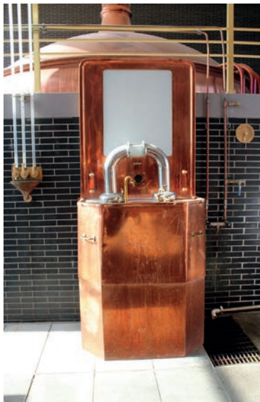
Från silckarspanelerna som också kallas provtagningspaneler tas prov på den färdigsilade vörten, den så kallade förvörten, ur tappkranar. Bilden visar panelen tillhörande det avställda silckaret. Foto HL.
