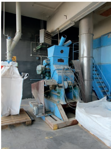
På plan 7 står den gamla remdriva malkrossen från 1930-talet. Till vänster syns säckar som fylls med damm från dammfiltret som finns på plan 8. Dammets säljs sedan till biogas. Till höger skymtar en av skrotbehållarna som för den krossade malten, skrotet, vidare till mäskpannan. Foto HL.
