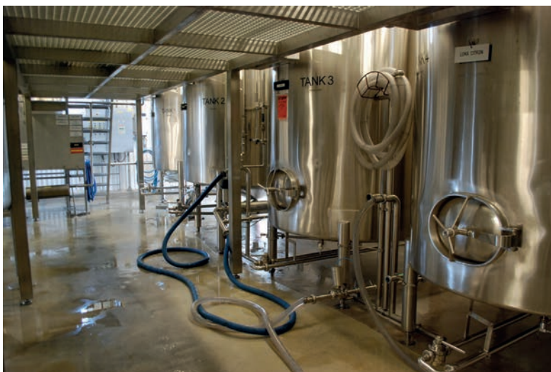
Syruptankar där skyltar hängs på varje tank för att personalen ska veta vilken sorts syrup som finns i behållaren. När tanken är rengjord sätts en skylt med CIPad på tanken istället.
