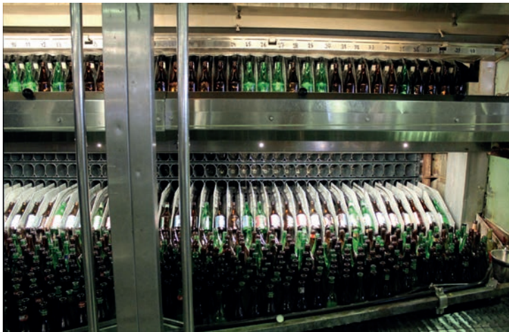
Glaset åker in i och ut ur tvätten på samma sida av maskinen. De nedre glasen på bilden är på väg in i maskinen där de läggs i flaskkorgar som en efter en åker ner i maskinen. När glasen är färdigtvättade kommer de ut ovanför flaskintaget och går sedan vidare i processen på flasktransportörer. Listen ovanför glasen är en dropplist som är formad så att eventuellt kondensvatten ska droppa mellan istället för i glasen. Foto HL.
