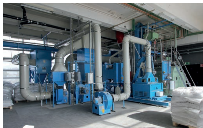
Maltkrossanläggningen på plan 8. Den bakre blå lådan till vänster i bild är ett dammfilter som skakar ner damm från malten i dammsäckar som finns på plan 7. Framför syns delar av fläktsystemet. Till höger syns den blå stenavskiljaren som står och skakar för att avskilja sten och eventuella metallbitar från malten innan krossningen. Bakom den finns rensmaskinen som tar bort lättare föroreningar i malten innan den går in i stenavskiljaren. Längst till höger står den gröna maltkrossen. Bakom alla dessa maskiner finns en rund blandningsbehållare som fungerar som en buffertbehållare för malt. Foto HL.
