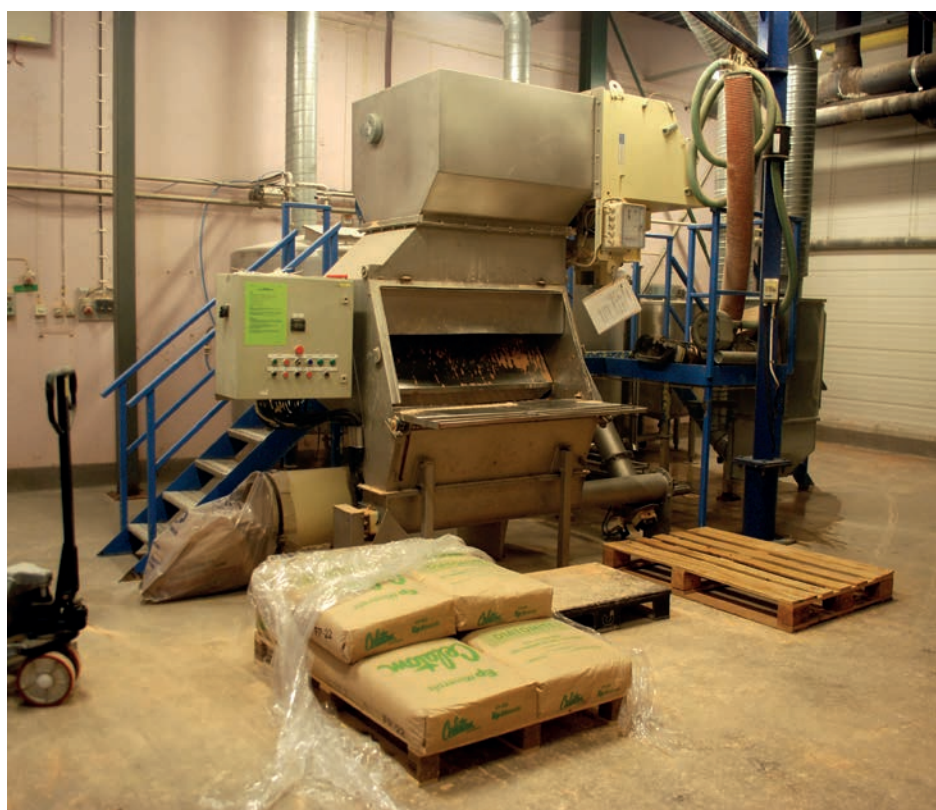
Kiselgur kommer till bryggeriet i säckar. Med hjälp av en säcktömmare som syns på den här bilden, och en transportsnäcka förs materialet till en behållare i filterrummet där det blandas med vatten och förs in i filtret. Foto LKU.
