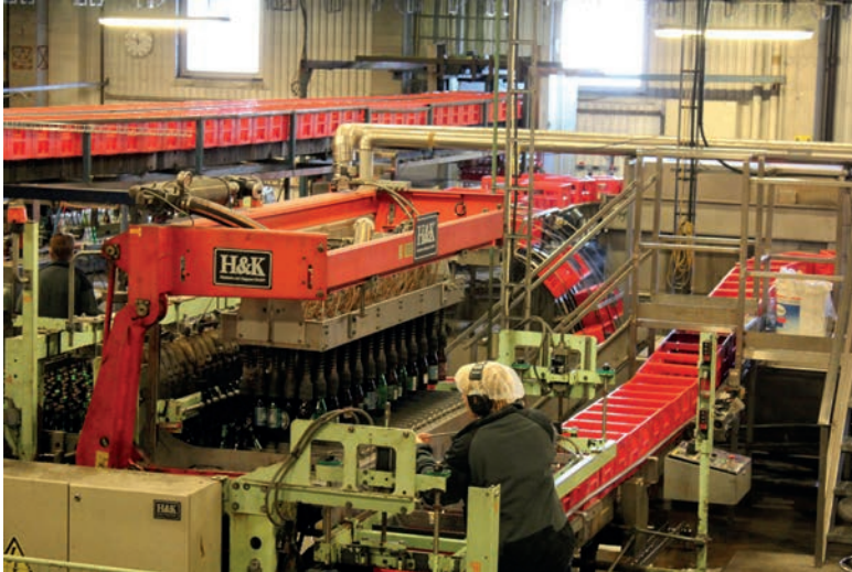
Sorterade färgade 33 cl glas lyfts i backar vid backfyllaren. Kvinnan på bilden håller på att resa upp en flaska som fallit omkull. Halvvägs upp mot taket syns en lång rad med röda tombackar som är på väg till backtvätten. Foto HL.
