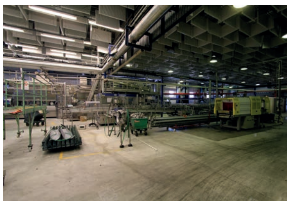
Den aseptiska linjen. Tappmaskinen står längs med väggen. Till höger i bild syns en maskin med gula detaljer. Detta är en ugn där plastförpackningen runt flaskorna smältes ihop för att hålla flaskorna på plats. Till vänster om den stod själva förpackningsmaskinen som plastade in flaskorna. Den är numera bortplockad. Foto HL.
