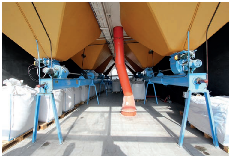
Skrotbehållarna på plan 7. Bortanför dessa står den gamla malkrossen. Den blå anordningen som står bredvid stapeln med pall, är en liten våg där brygdens totala volym vägs in. På våningsplanet förvaras säckar med malt samt hinkar med humle. Foto HL.
