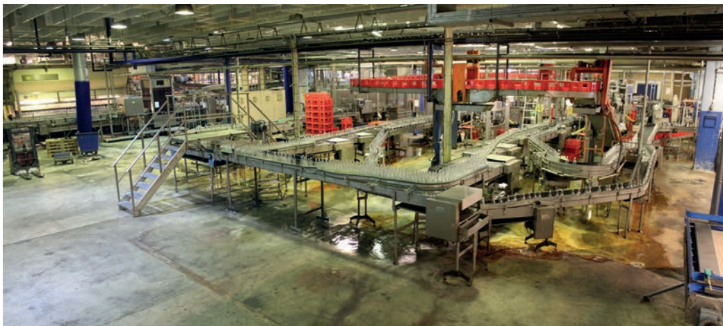
Kolonn 13. Översiktsbild över flasktransportörerna vid de två etiketteringsmaskinerna. De transportörer där det står många glas går till etiketteringsmaskinerna, den borte heter 13:1 och den närmast i bild heter 13:2. Till höger i bild syns två flasktransportörer där glasen åker en och en i rad, dessa glas är färdiga och på väg till backfyllaren. Foto HL.
