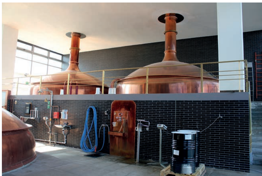
Silkaren. Det vänstra är ur drift och det högra är i drift. Bakom den låga kaklade väggen finns silkarens nedre delar. Till höger om den blå slangen syns den silkarspanel som hör till silkaret i drift. Foto HL.
