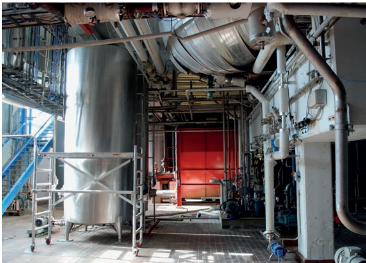
På plan 2 i brygghuset har ett virrvarr av rörledning, pumpar, behållare och annan utrustning samlats. Här lagras också tunnor med maltextrakt som används som färgämne för att göra vissa ölsorter extra mörka. På bilden syns två hetdruvstankar för druv som har separerats ur vörten (till vänster), den röda behållaren för drav och underdelen på den gamla avställda vörtpannan (överst). Foto LKU.
