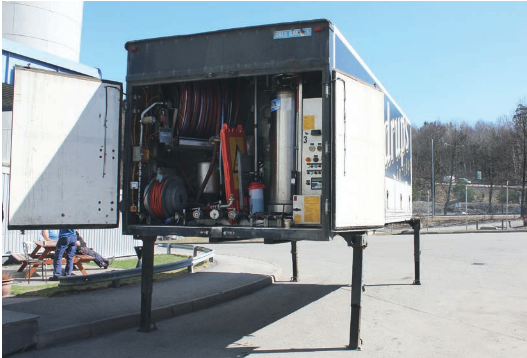
Fem bilar med släp levererar öl till stora restauranger. Bil och släp består av stora skåp och i varje skåp finns två tankar som vardera rymmer 11 000 liter öl. Det som syns på bilden är slangar och annat, själva tankarna finns bakom. Alla tankar som finns i bilarna CIPas alltid innan de ska fyllas med nytt öl. Foto HL.
