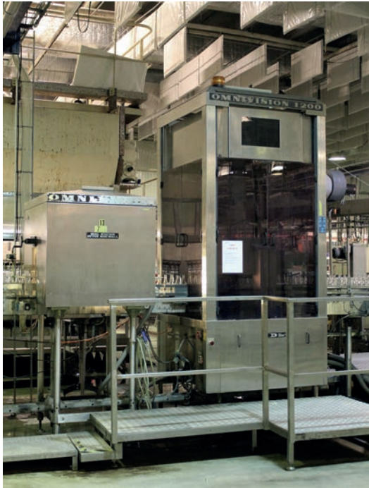
Kolonn 13. Syningsmaskinens framsida. Glasen kommer först till den vänstra maskinen som med hjälp av syningslampor kontrollerar att glasen är rena och sedan åker de vidare till den högra maskinen som kontrollerar att de är hela. Foto HL.
