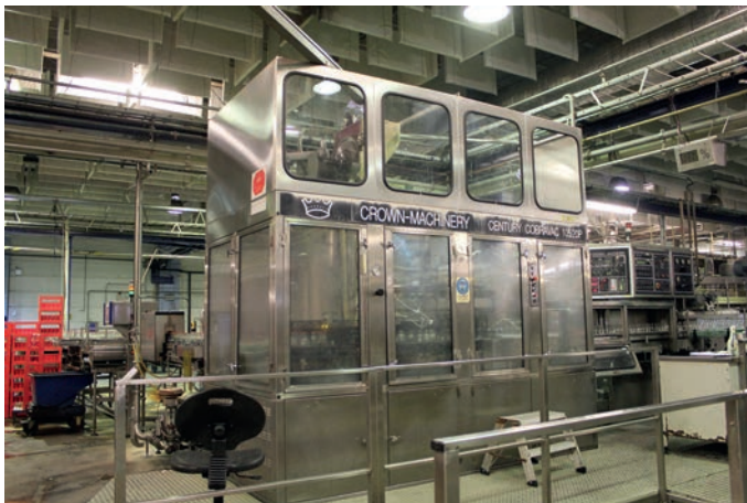
Kolonn 13. Syningsmaskinens framsida. Glasen kommer först till den vänstra maskinen som med hjälp av syningslampor kontrollerar att glasen är rena och sedan åker de vidare till den högra maskinen som kontrollerar att de är hela. Foto HL.
