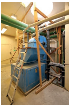
Vägen som väger den inkommande malten innan den går till respektive maltsilo. Foto HL.
