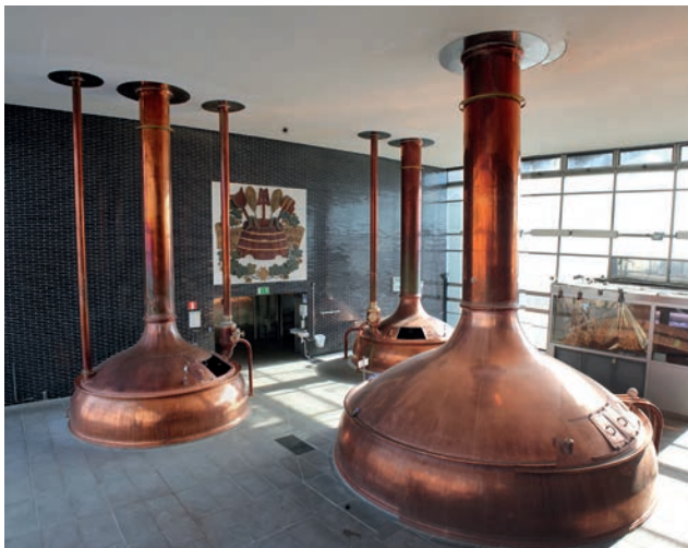
De två mäskepannorna, den gamla vörtpannan till höger. I mäskepannornas kraftiga rör kommer malt ner från skrotbehållarna, i de tunna rören som kommer upp genom golvet förs vatten in i mäskepannornas blandningskammare. De kraftiga kopparrören som går från vörtpannan och silkaren upp genom taket för ut ånga från respektive behållare. Röret till vänster på den vänstra vörtpannan kommer från den gamla krossen som fungerar som reservkross. Foto HL.
