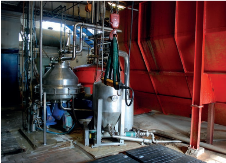
Från utslagskaret kommer den heta vörten ner till plan 2 i brygghuset. Här finns diverse produktionsutrustning, bland annat för separering av druv och kylning av vört. Den vänstra rostfria behållaren på bilden ovan är druvseparator som vörten anländer med hög fart. Efter separeringen går druvan vidare till den högra rostfria behållaren, och därefter till två hetdruvstankar på samma plan. I den stora röda behållaren i bildens högra del samlas drav som har silats bort vid mäsningen. Draven matas ut från behållaren med tryck och vidare med en skruvtransportör. Den lilla röda behållaren är en omrörare till silket som befinner sig på våningen ovanför. Foto LKU.
