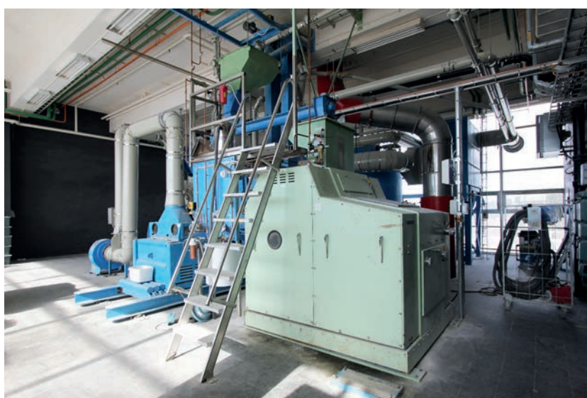
Maltkrossen är en torrskross med konditioneringsnäcka som fuktar malten med 60 °C vatten. Krossen, som har tre valsar, är ny sedan 4-5 år tillbaka. Foto HL.
