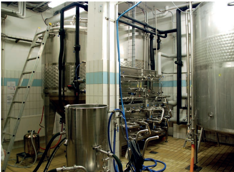
Bryggeriets jästrum förses med jäst från laboratoriet för vidare odling i två slutna propageringskärl som är utrustade med värmeslinga respektive kylslinga för sterilisering och kylning av vörten. Framför de bägge kärlen finns en kontrollpanel varifrån processen styrs. För att underlätta den viktiga rengöringen är väggarna försedda med kakel och golvet är täckt med klinker som går lätt att spola av. Foto LKU.
