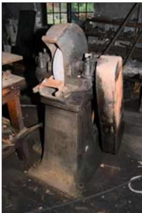
Fig 40. Remdriven smärjelmaskin (golvmoddell). Tillverkare: Naxon-Union, Frankfurt, Ammain. Foto: Mattias Ek 2005. Bildbeteckning: Lx2005-1563.
