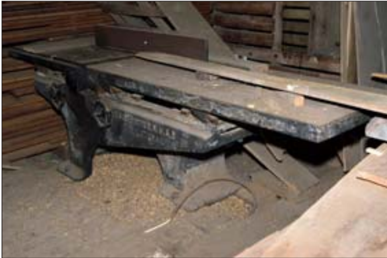
Fig 48. Remdriven hyvel, s k 600 hyvel (600 skär). Tillverkare: E.V. Beronius M.V.A.B. Eskilstuna. Foto: Mattias Ek 2005. Bildbeteckning: Lx2005-1552.
