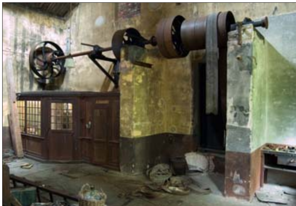
Fig 34. Ovanför det avplankade kontoret i maskinrummet går kraftöverföringsstången igenom väggen till smedjan. Foto: Mattias Ek 2005. Bildbeteckning: Lx2005-1573.
