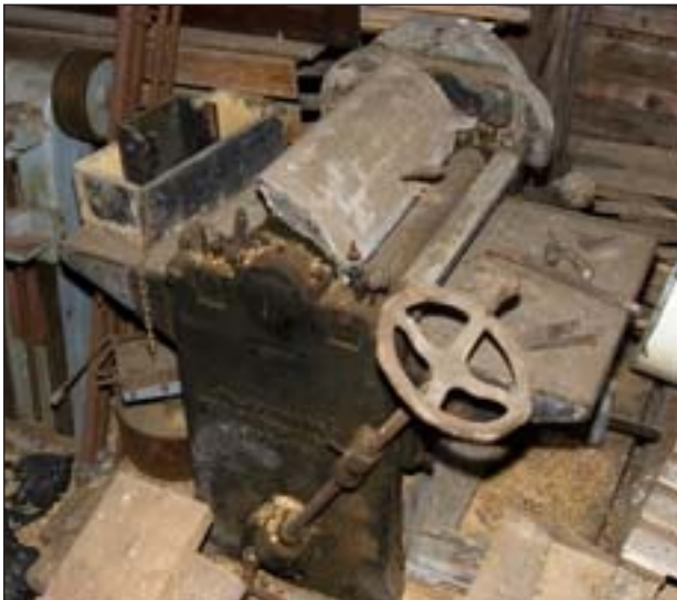
Fig 50. Remdriven planhyvel. Tillverkare: Falkenbergs nya verkstad. Foto: Mattias Ek 2005. Bildbeteckning: Lx2005-1555.
